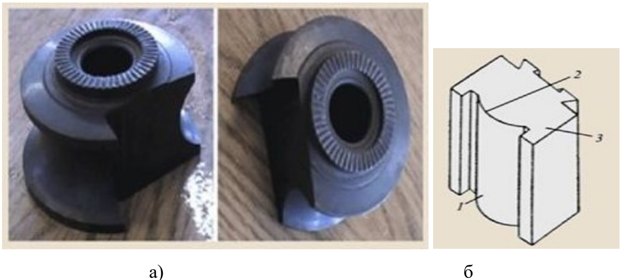
а) фасонний круглий різець; б) призматичний фасонний різець; Рисунок 2.1 – Конструкції фасонних різців.
