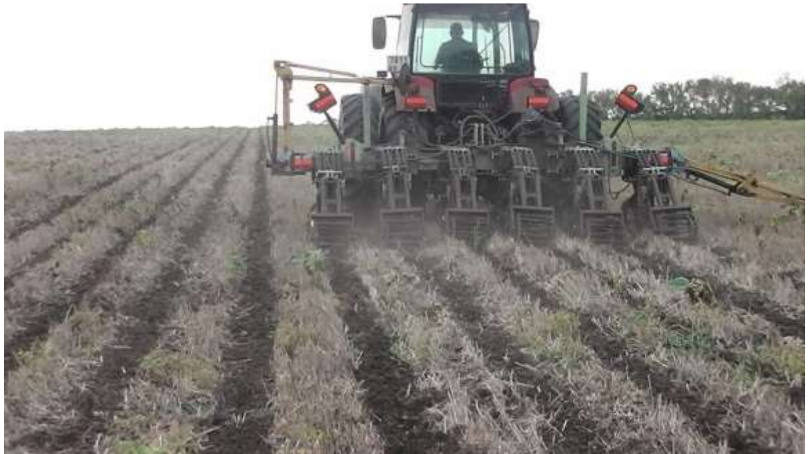
Рис.1 Нарізка смуг МТЗ-1523 + культиватор Ортман
