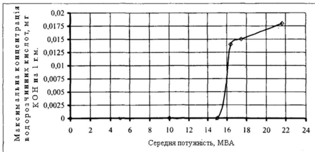
Рис. 4.7 – Залежність максимальної концентрації водорозчинних кислот від середньої потужності трансформатора
