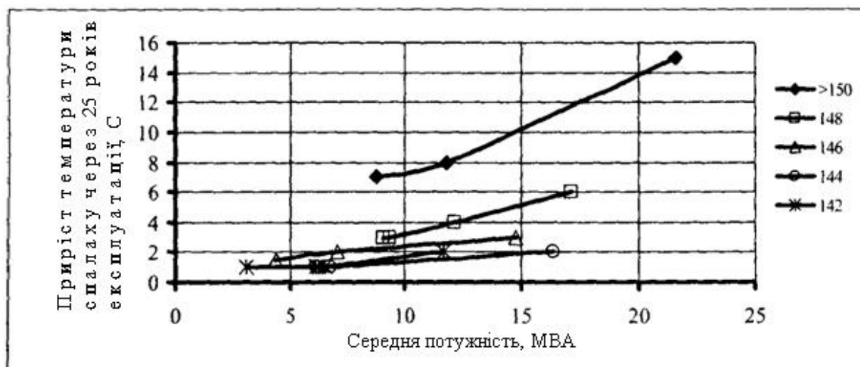
Рис. 4.10 – Залежності значення приросту температури спалаху через 25,0 років експлуатації від середньої потужності для трансформаторів, які мають різне значення температури спалаху на момент заливки оливи
