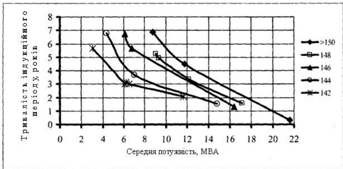
Рис. 4.9 – Залежності тривалості індукційного періоду температури спалаху від середньої потужності для трансформаторів, які мають різне значення показника на момент заливки оливи
