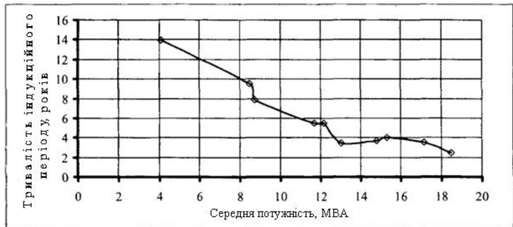
Рис. 4.12 – Залежність тривалості індукційного періоду пробивної напруги оливи від середньої потужності трансформаторів
