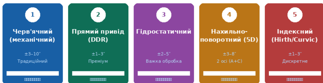
Рис. 2.1. Класифікація поворотних столів за принципом дії
