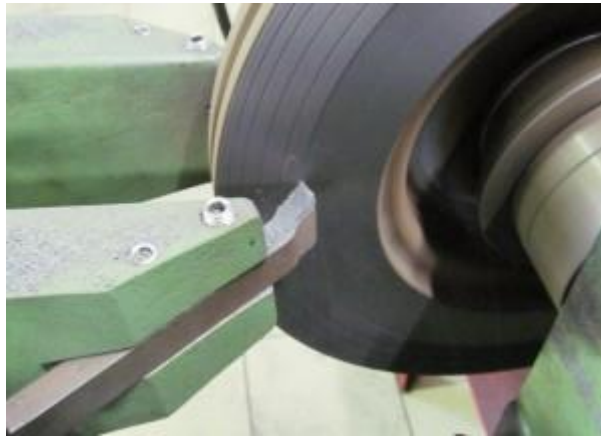
Рисунок 3.1 – Правка гальмівного диска
