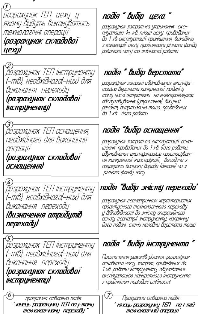
Рисунок 1 – Схематична послідовність виникнення клавішних подій при діалоговому проектуванні РТП
