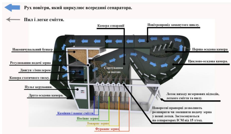
Рис. 8. Принципова схема роботи горизонтального (похилого) повітряного потоку
