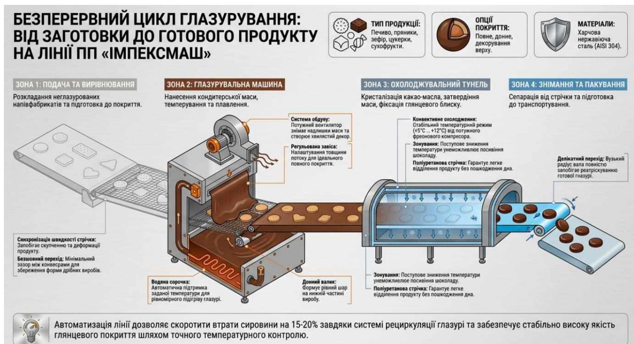
Рисунок 1.1 – Схема (лінія) виробництва глазуrowаних виробів
