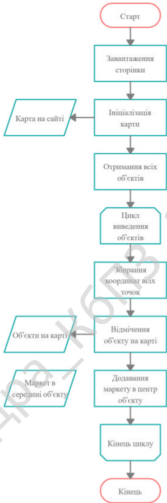
Рисунок 4.3 – Блок-схема алгоритму відображення об'єктів
