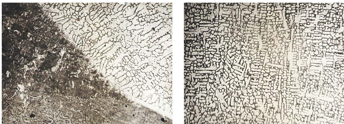
Рисунок 5 – Мікроструктура перехідної зони (а) і крапкового покриття (б), зміцненого порошковим дротом ПП-АН170 на сталі Л53:х100
