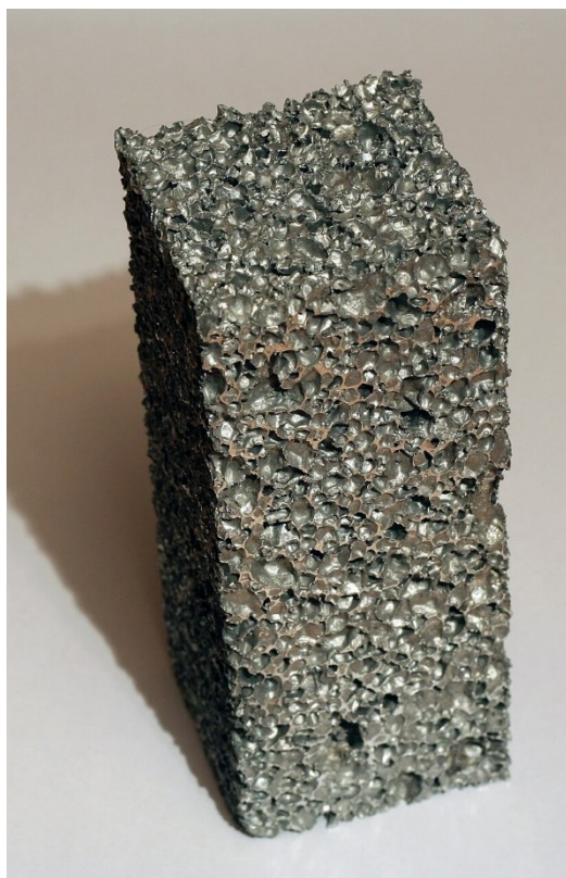
Литий піноалюмінієвий блок з закритими порами
