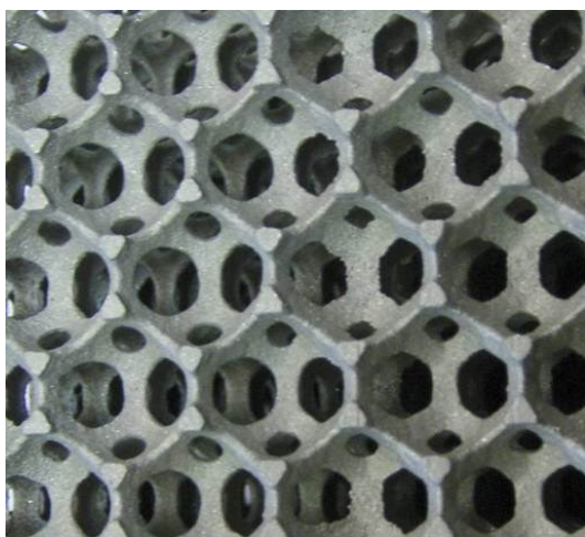
Піноалюміній з регулярною структурою порожнин
