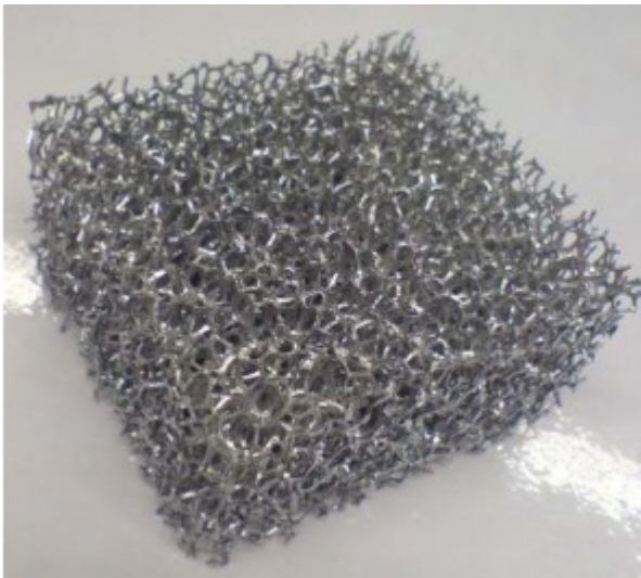
Алюмінієвий пінометал з відкритими (негерметичними) порами
