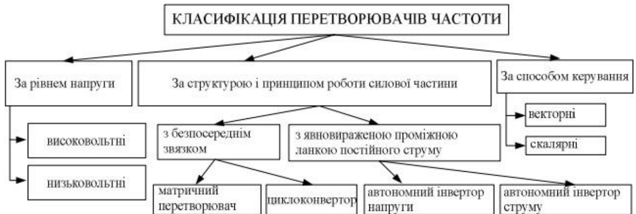
Рисунок 2.4 Класифікація пристроїв для перетворювання частоти
