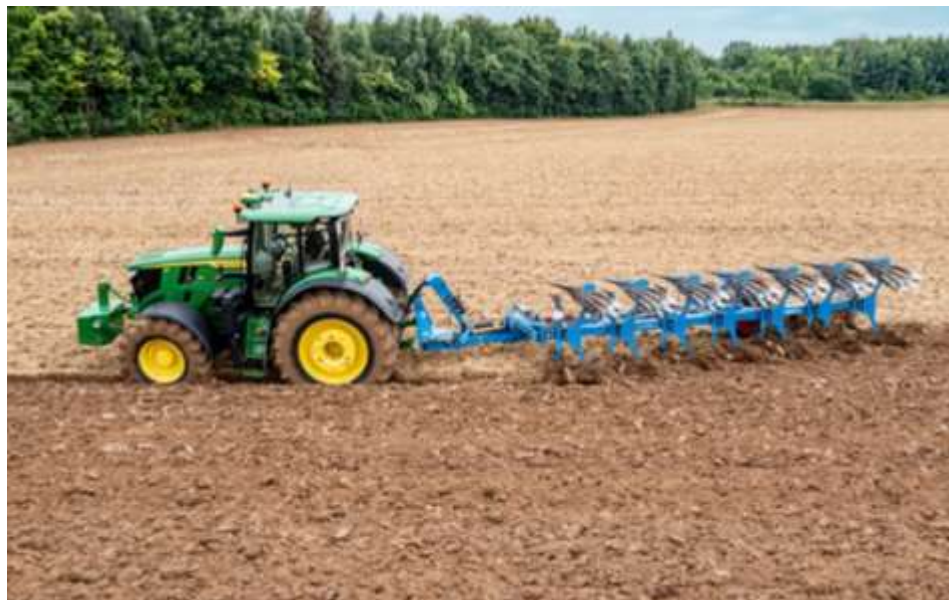
Рис. 1.1. Загальний вигляд знаряддя для полицевої оранки
