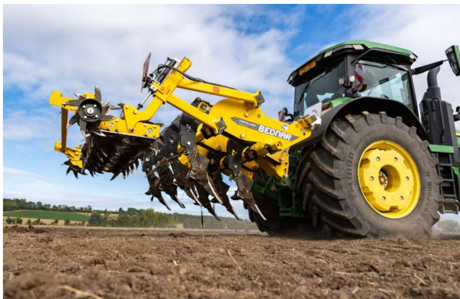
Рис. 1.2. Загальний вигляд навісного глибьокорозпушувача Terraland TN
