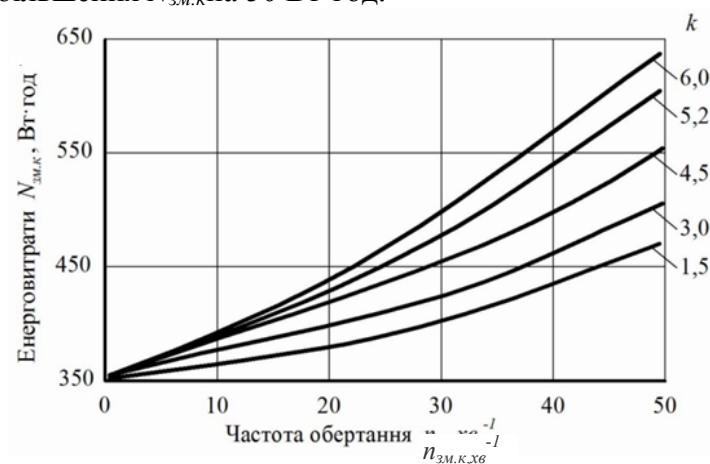
Рисунок 4 – Залежність енерговитрат привода змішувальної камери від частоти обертання контейнера та зміни коефіцієнта режиму вібрації
