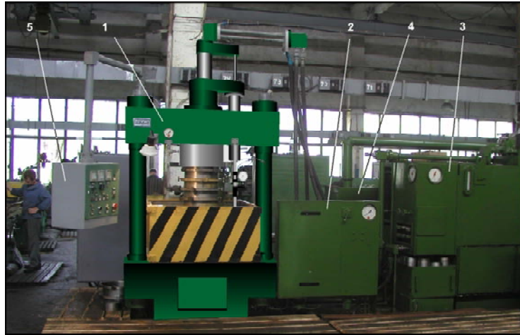
1 – верстат; 2 – пульт керування; 3 – станція робочої рідини; 4 – джерело живлення технологічним струмом; 5 – пульт керування Рисунок 1 – Електроерозійний верстат «АМ-1»
