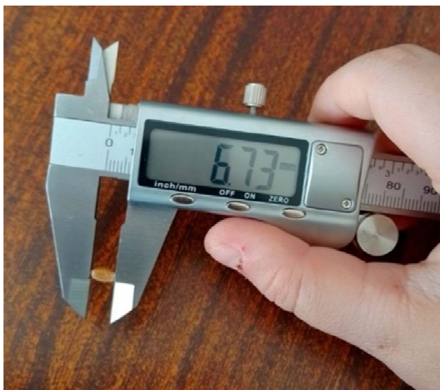
Рисунок 4 – Визначення геометричних розмірів зерен пшениці Джерело: розроблено авторами
