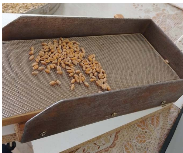
Рисунок 1 – Загальний вигляд нахиленої площини, для визначення коефіцієнта тертя Джерело: розроблено авторами
