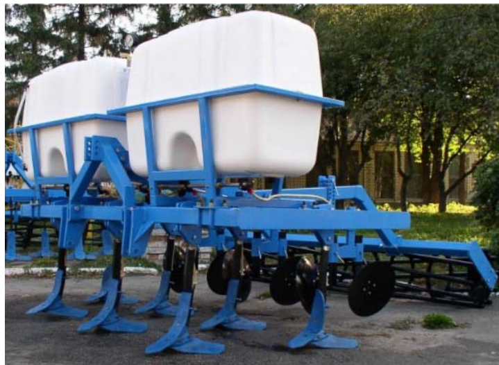
Рисунок 1 – Культиватор КУ-3А з обладнання для внесення КАС (Богуславська сільгосптехніка)
