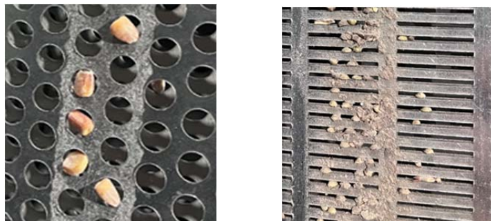
Рисунок 10 – Приклади наявності неочищених зон на ППП
