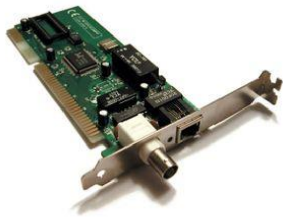
Рисунок 1.6. Мережна плата з обома роз'ємами BNC (зліва) і RJ45 (справа).
