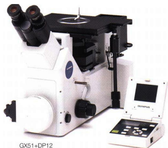
Рисунок 2.5 - Оптичний інвертований мікроскоп "OLYMPUS GX51"
