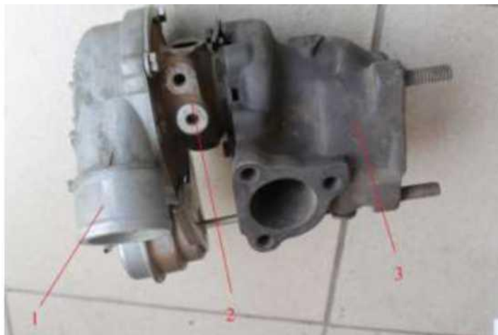
1 - корпус компресора, 2 - середній корпус , 3 - корпус турбіни Рисунок 3.1 - Турбокомпресор Garrett GT 2049 S для двигуна 2.0 TDI Transit V.
