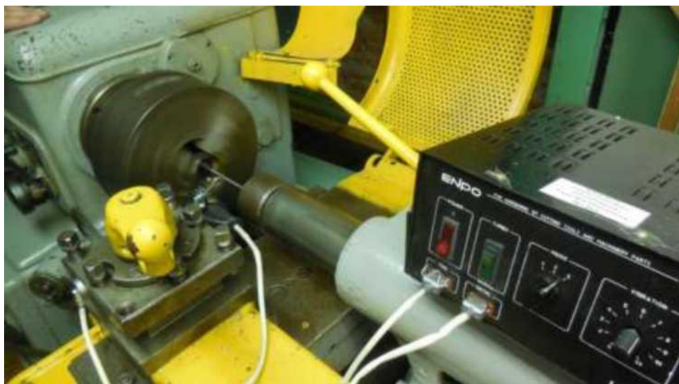
Рисунок 4.1 - Процес обробки опорних поверхонь валу ротора ТКР під підшипник та ущільнювальну втулку.
