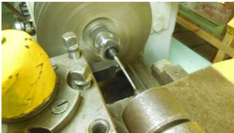
Рисунок 4.2 - Вигладжування поверхні валу ТКР після ЕІО
