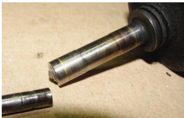
Рисунок 3.3 – Вигляд вала ротора ТКР від дії втомного руйнування
