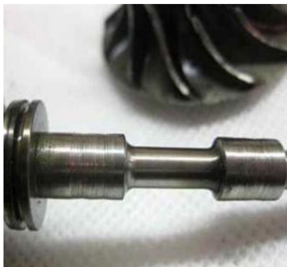
Рисунок 3.5 - Сліди гідроабразивного зношування вала ротора ТКР
