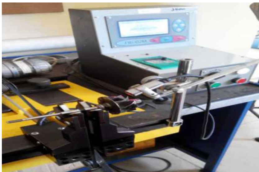
Рисунок 4.3 - Балансувальний дорезонансний верстат БВІ-03-02Т
