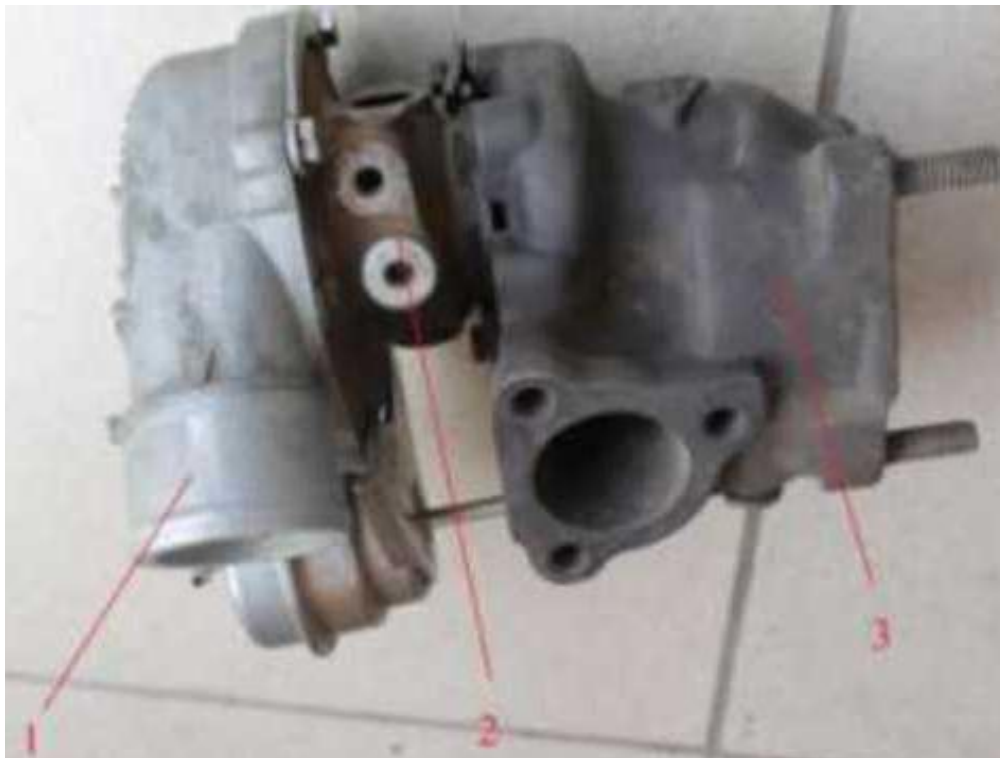
1 - корпус компресора, 2 - середній корпус , 3 - корпус турбіни
