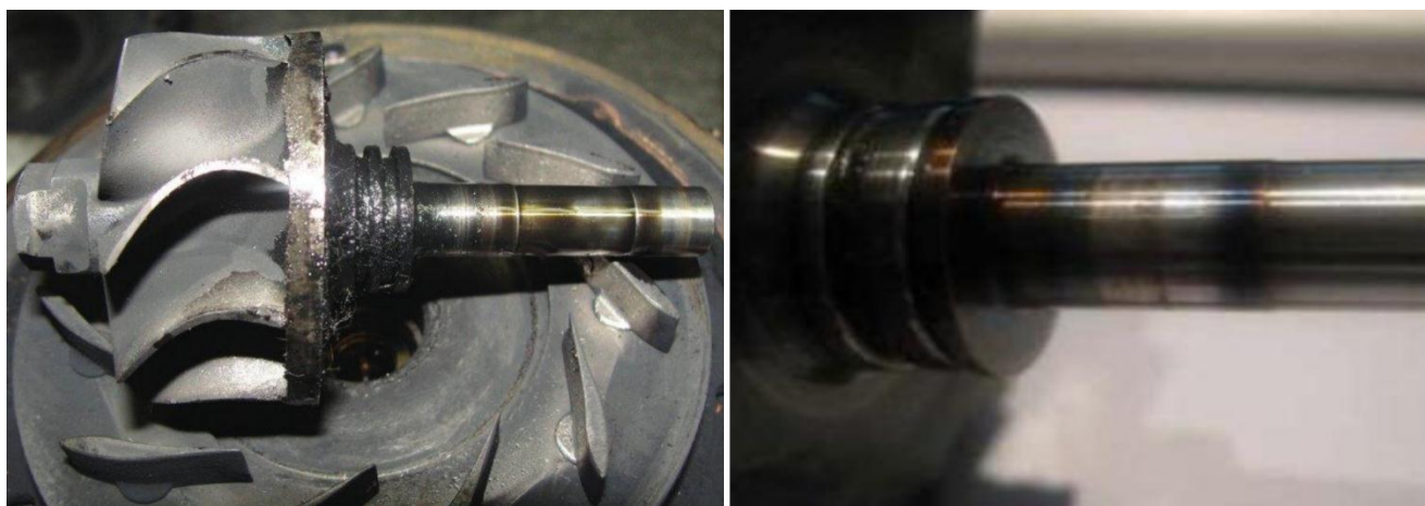
Рисунок 3.4 - Вигляд вала ротора ТКР при дії термічного впливу
