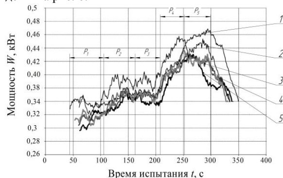
Рис. 6 – Характер изменения мощности, потребляемой компрессором во времени при ступенчатом нагружении: 1 - базовое моторное масло М10Г 2 к; масло с присадками: 2 - "Roil Gold", 3 - "НИОД-5"; 4 - "КГМТ-1"; 5 - дисульфид молибдена; P_1 = 0,1 МПа; P_2 = 0,2 МПа; P_3 = 0,3 МПа; P_4 = 0,4 МПа; P_5 = 0,5 МПа
