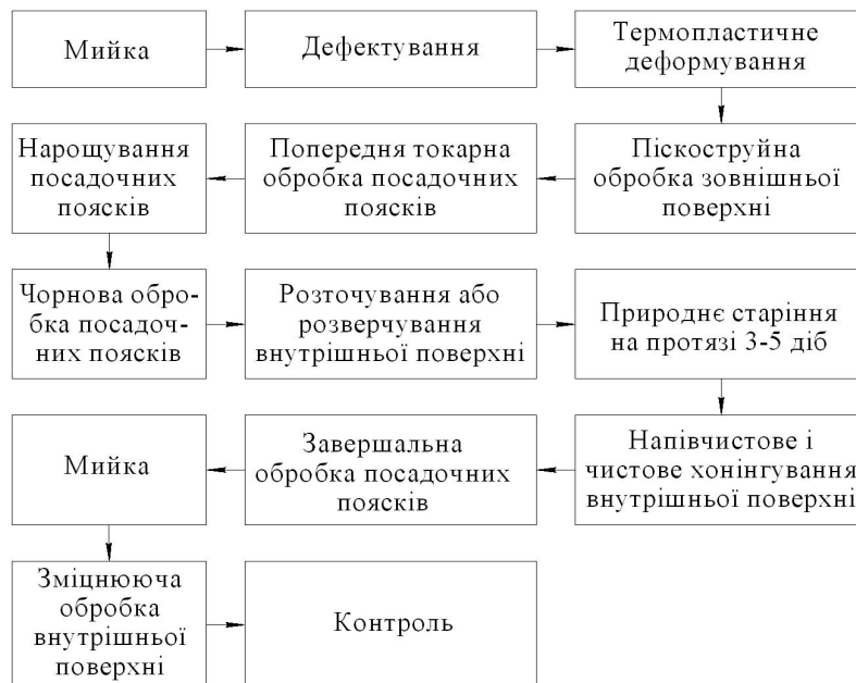
Рисунок 1 – Схема технологічного процесу відновлення гільз циліндрів методом термопластичного деформування
