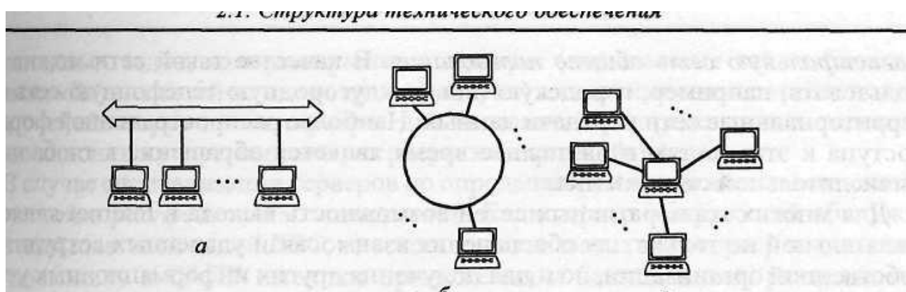
Рисунок 2 - Варіанти топології локальних обчислювальних мереж а — шинна; б — кільцева; у — зоряна
