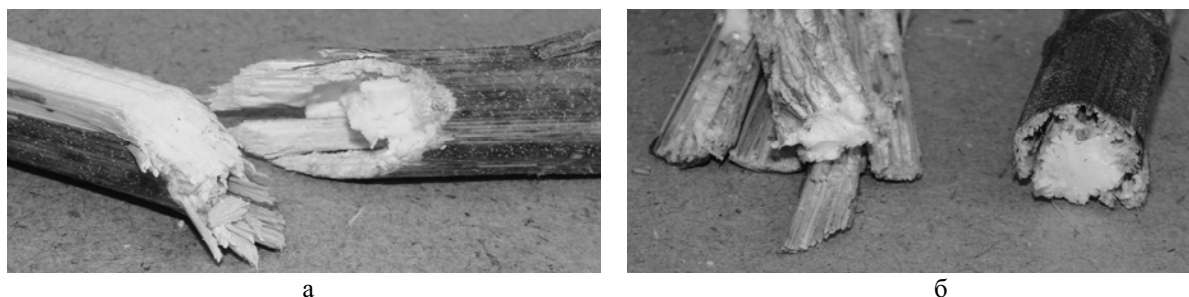
а – \alpha = 20^\circ ; б – \alpha = 35^\circ
