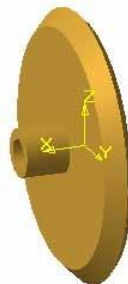
Рисунок 7.3 – Модель конічного зубчастого колеса
