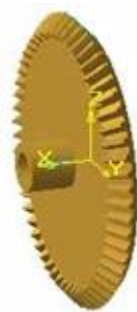
Рисунок 7.10 – Модель кінчного зубчастого колеса
