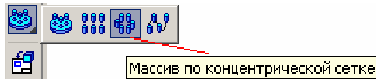
Рисунок 4.21 – Створення масиву по концентричній сітці
