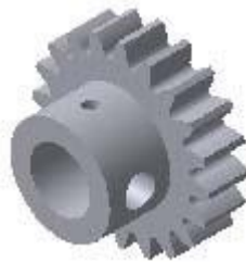
Рисунок 6.33 – Модель отвору під гвинт
