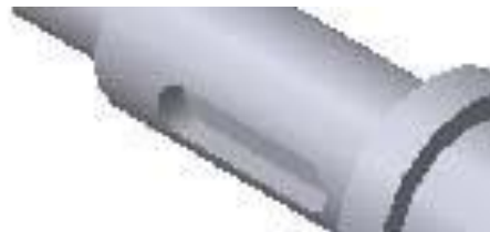
Рисунок 5.24 – Модель призматичного шпонкового паза
