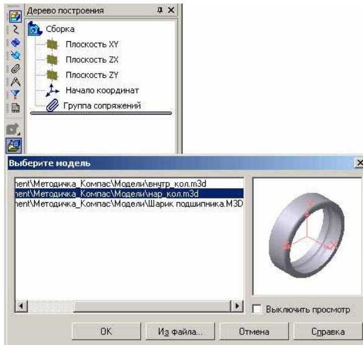
Рисунок 4.13 – Додавання файлу зовнішнього кільця
