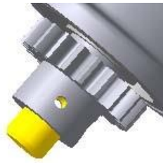
Рисунок 8.9 - Модель циліндричного колеса встановленого на валу
