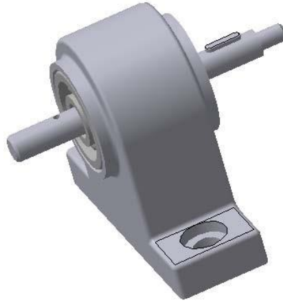
Рисунок 8.7 – Модель валу із шпонкою
