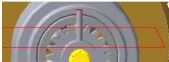
Рисунок 8.10 – Установка штифта в отвір
