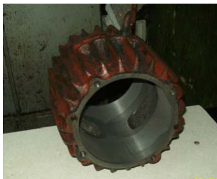
Рисунок 3 – Напилений і розточений корпус пластинчато-роторного вакуумного насосу РВН 40/350
