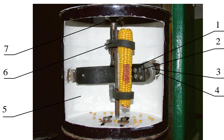
Рисунок 1 - Экспериментальная установка для изучения условий отделения зерна от початка кукурузы
