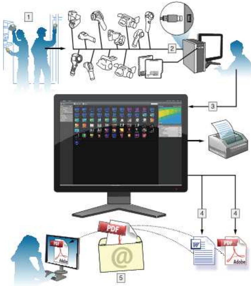
Рис. 1.2. Послідовність обробки термограм у програмі FLIR Tools
