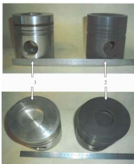
1 - без обробки; 2 - після вакуумного азотування в пульсуючому пучку плазми
