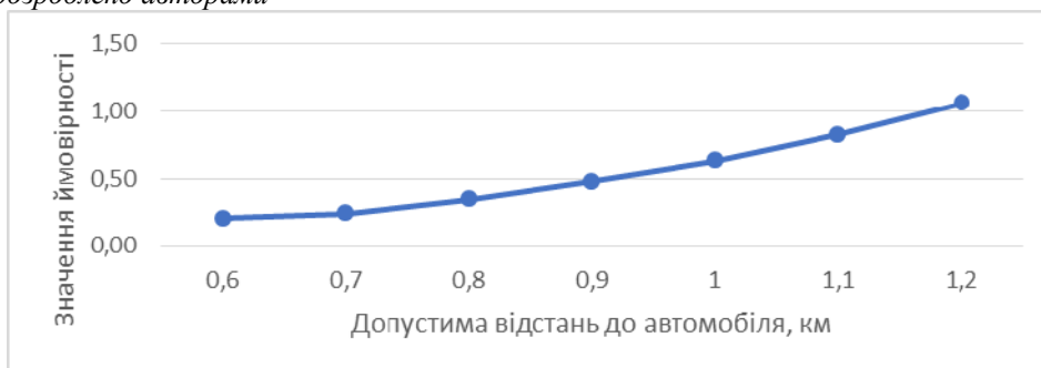
Рисунок 14 – Графічна залежність ймовірності існування вільного ТЗ в районі, де є 4 вільних ТЗ на відстані від 0,6 до 1,2 км
