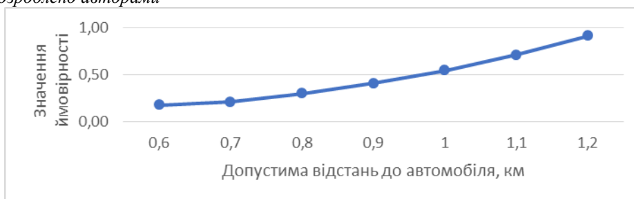
Рисунок 12 – Графічна залежність ймовірності існування вільного в районі, де є 3 вільних ТЗ на відстані від 0,6 до 1,2 км
