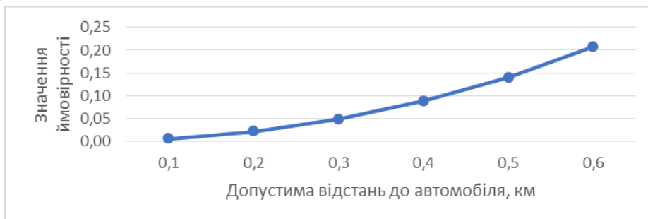
Рисунок 13 – Графічна залежність ймовірності існування вільного ТЗ в районі, де є 4 вільних ТЗ на відстані від 0,1 до 0,6 км
