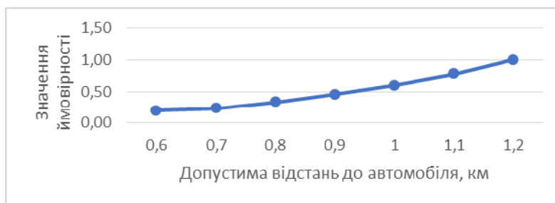
Рисунок 15 – Графічна залежність ймовірності існування вільного ТЗ в районі, де є 1 вільний ТЗ на відстані від 0,6 до 1,2 км
