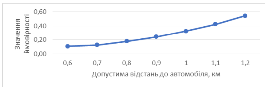
Рисунок 8 – Графічна залежність ймовірності існування вільного в районі, де є 1 вільний ТЗ на відстані від 0,6 до 1,2 км
