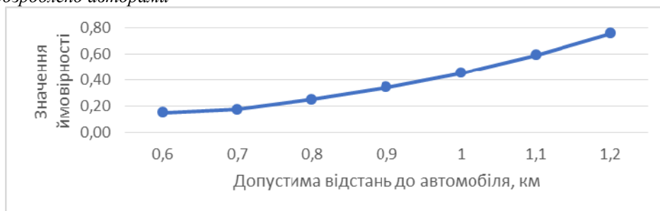
Рисунок 10 – Графічна залежність ймовірності існування вільного в районі, де є 2 вільних ТЗ на відстані від 0,6 до 1,2 км
