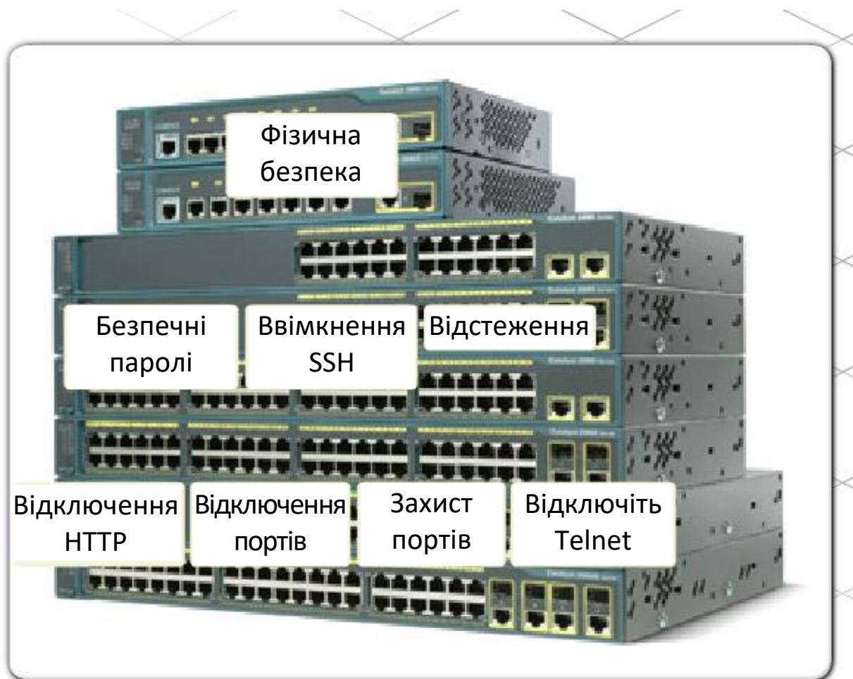
Рисунок 9.11 – Реалізація безпеки мережі на апаратному рівні
