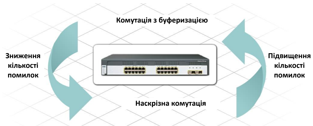
Рисунок 9.10 – Різниця між комутацією з буферизацією і суцільною комутацією
