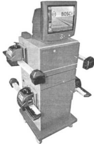
Рисунок 44 - Комп'ютерний комплекс для аналізу геометрії ходової частини автомобіля.
