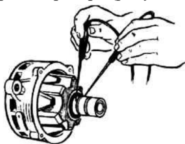
Рисунок 16. – Перевірка обмотки збудження генератора на обрив.
