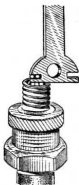
Рисунок 22. – Регулювання зазору між електродами свічки запалювання за допомогою спеціального ключа.
