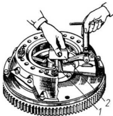
Рисунок 33 – Перевірка та регулювання розміщення важелів за допомогою пристосування і контрольної пластини:
