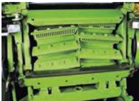
Рис. 2.5. Подрібнюючий барабан V-CLASSIC кормозбиральних комбайнів JAGUAR 800-ої серії
