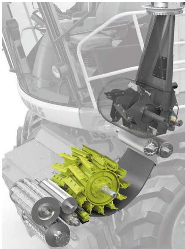
Рис. 2.2. Системи подачі подрібнення та відвантаження матеріалу кормозбиральних комбайнів CLAAS JAGUAR 800-ої серії
