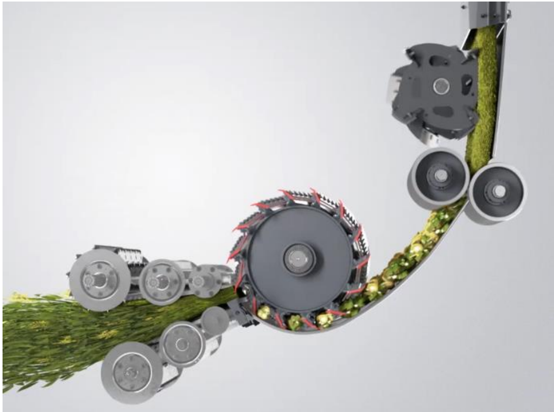
Рис. 2.20. Схема потоку маси в кормозбиральних комбайнах FENDT
