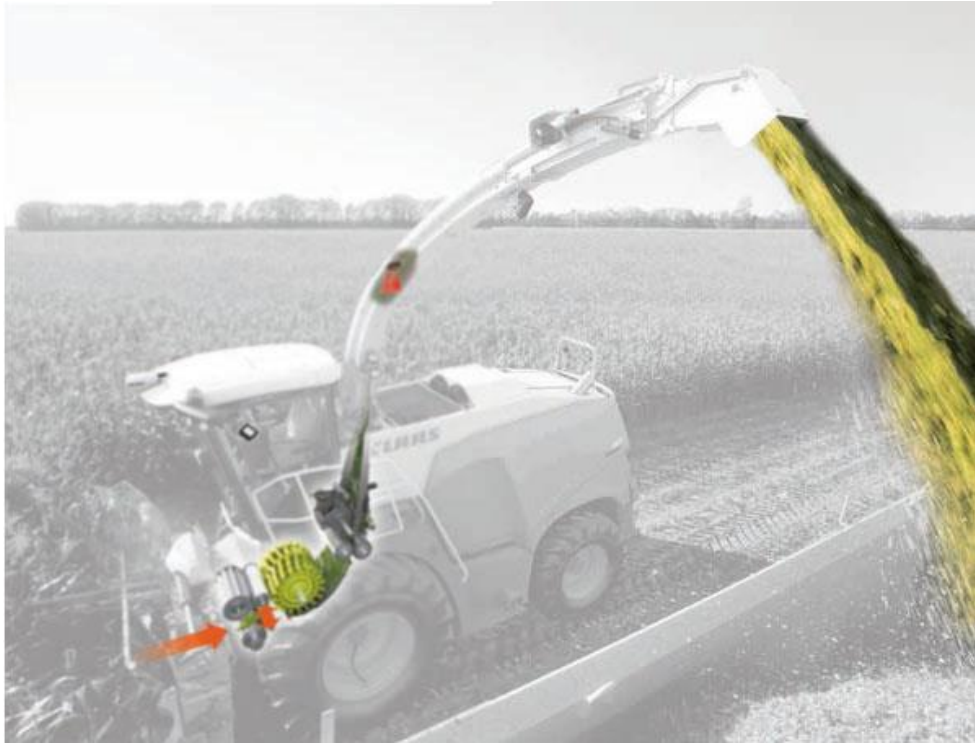
Рис. 2.1. Узагальнена схема технологічного процесу роботи кормозбирального комбайна
