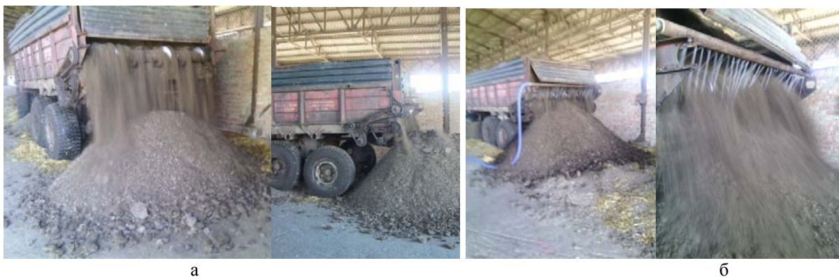
Рисунок 2 – Процес формування натурних буртів із використанням доопрацьованого розкидача органічних добрив ПРТ-10: а – без додаткового зволоження; б – із додатковим зволоженням
