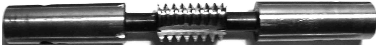
Рисунок 1 – Хвостова одновиткова спеціальна черв'ячна фреза [2]
