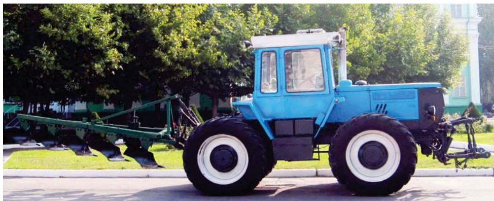
Рисунок 2 – Орний машино-тракторний агрегат, працюючий за схемою «0+5»
