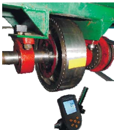
Рисунок 2 – Динамічне балансування валу Резонансна вібраційна машина
