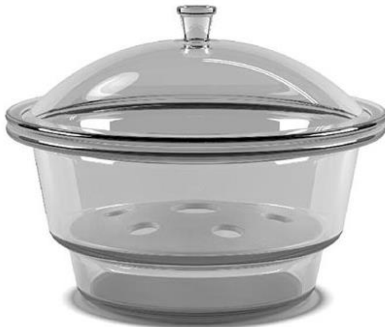
Рис.65. Лабораторний скляний ексікатор для зберігання мікрошліфів
