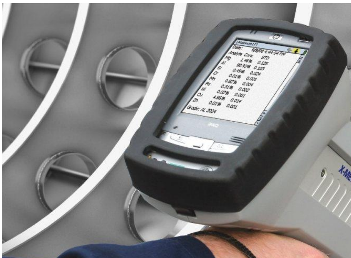
Рис.39. Виведення результатів спектрального аналізу на монітор портативного рентген флуоресцентного аналізатора
