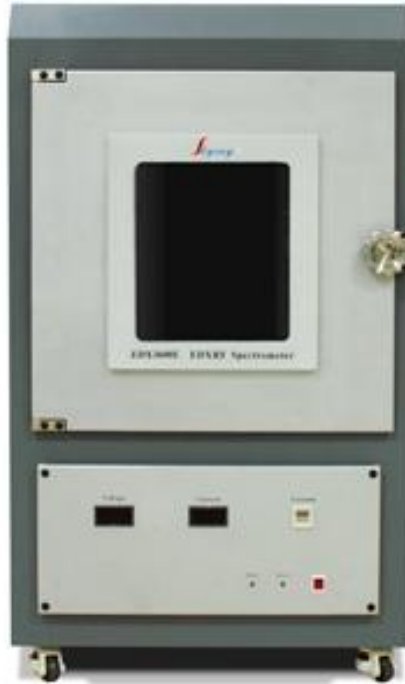
Рис.36. Рентгено-флуоресцентний аналізатор для дослідження історичних артефактів моделі EDX3600L
