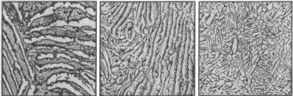
Рис.120. Різниця в дисперсності ферито – цементитної суміші в мікроструктурі сталі: перліт (а), сорбіт (б) та троостит (в) , 7500х
