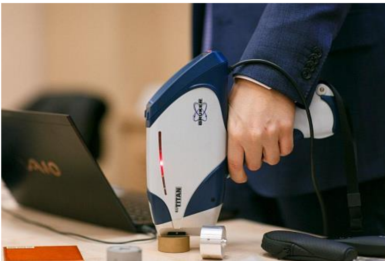
Рис.38. Проведення хімічного аналізу матеріалу портативним рентгенофлуоресцентним спектрометром
