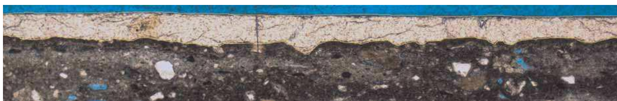
Рис. 151. Мікрофотографія тонкого зрізу шару глазурі товщиною 81–154 мкм на поверхні археологічної кераміки
