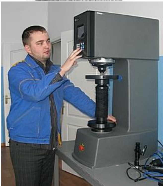
Рис.47. Схема визначення твердості за методом Брінелля (а): утворення відбитку (б); твердомір (прес) Брінелля (в)
