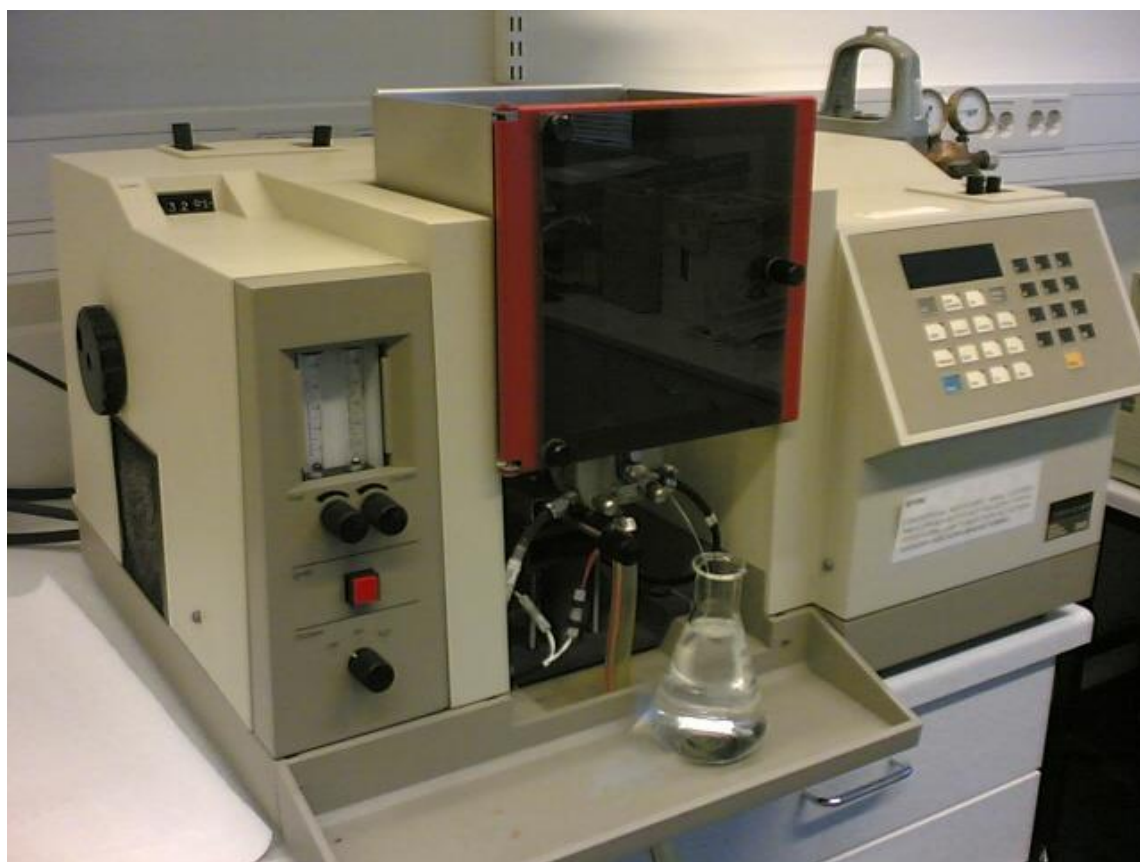
Рис.31. Спектрометр для проведення атомно-адсорбційного аналізу
