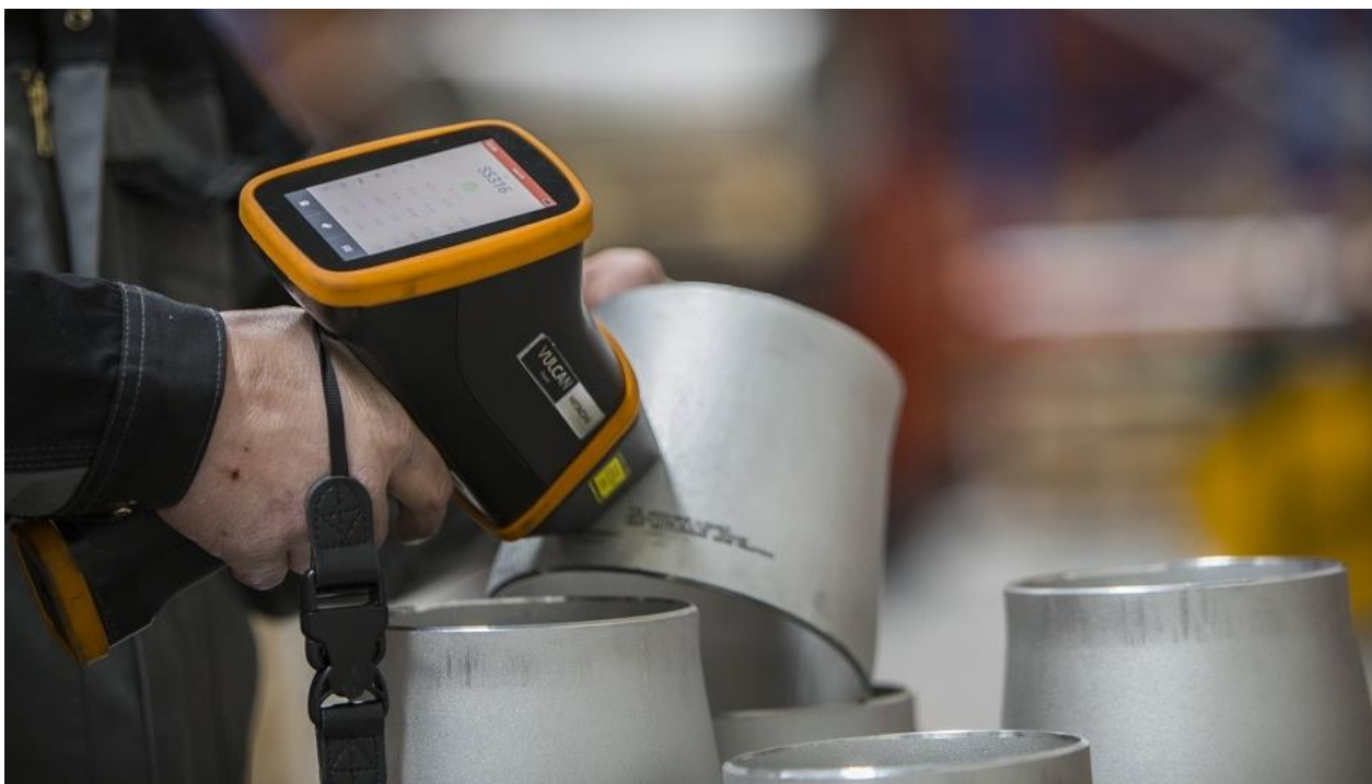
Рис.23. Проведення аналізу хімічного складу матеріалу портативним емісійним спектроскопом лазерно - індукованого пробую
