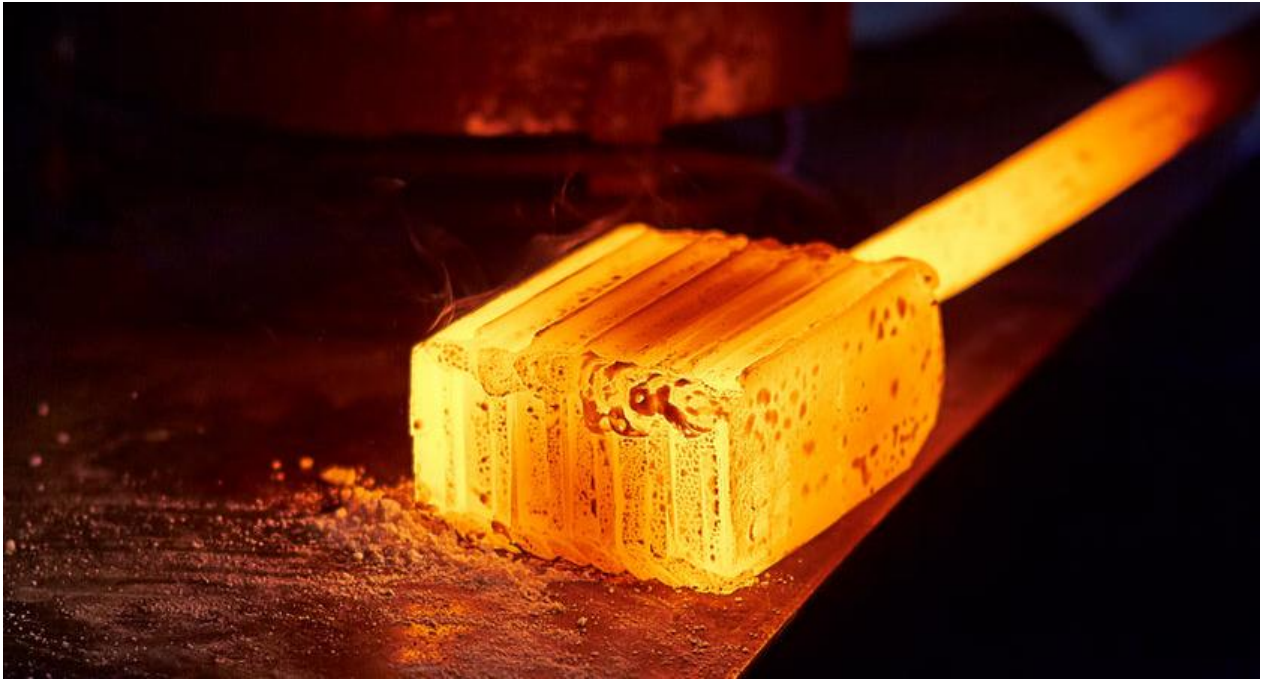
Рис.123. Розжарена заготовка для виготовлення артефакту з дамаської сталі перед куванням. Заготовка отримана шляхом зварювання по чергово розміщених пластин з твердої та м'якої сталі
