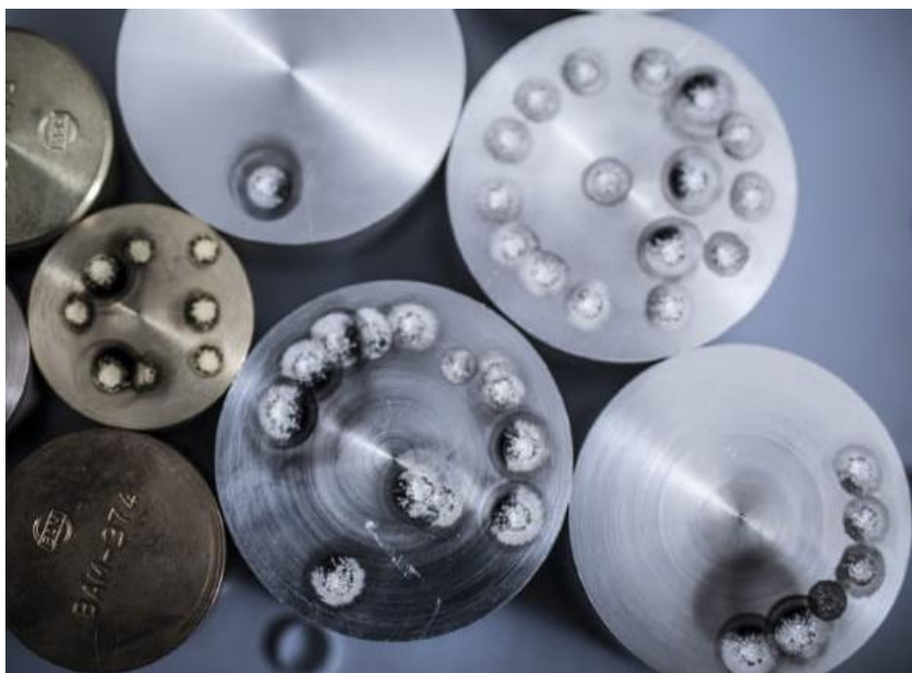
Рис.19. Плями «пропалення» на поверхні металевих проб після проведення атомного емісійного спектрального аналізу
