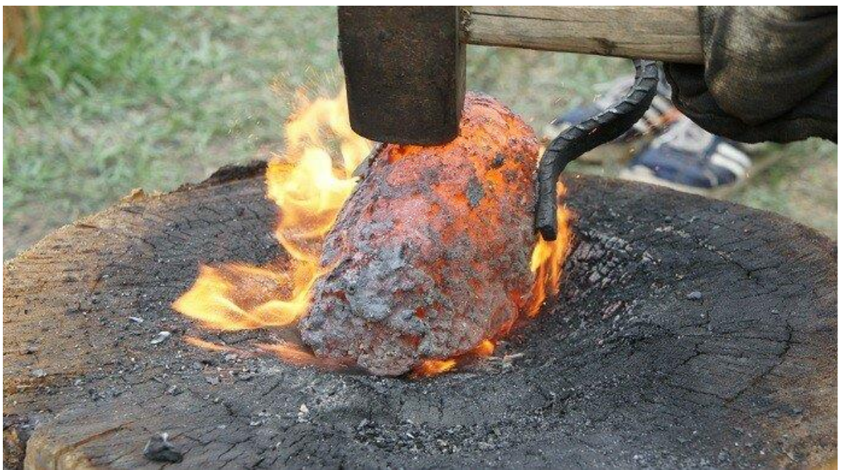
Рис.113. Проковування грудки криці
