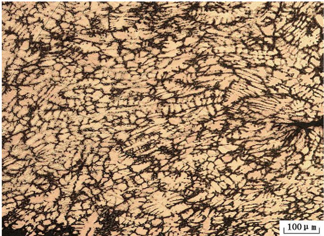
Рис.86. Деформація зерен бронзи з дендритною будовою після проведення холодного деформування
