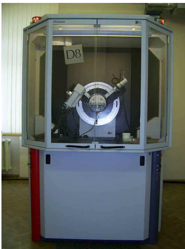
Рис.78. Рентгенівський дифрактометр призначений для рентгеноструктурних досліджень кристалічних матеріалів
