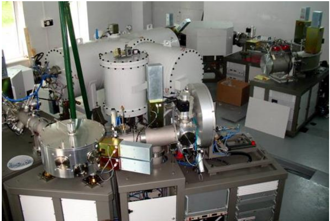
Рис.10. Прискорювальний мас-спектрометр Tandetrion в лабораторії Інституту прикладної фізики Національної академії наук України
