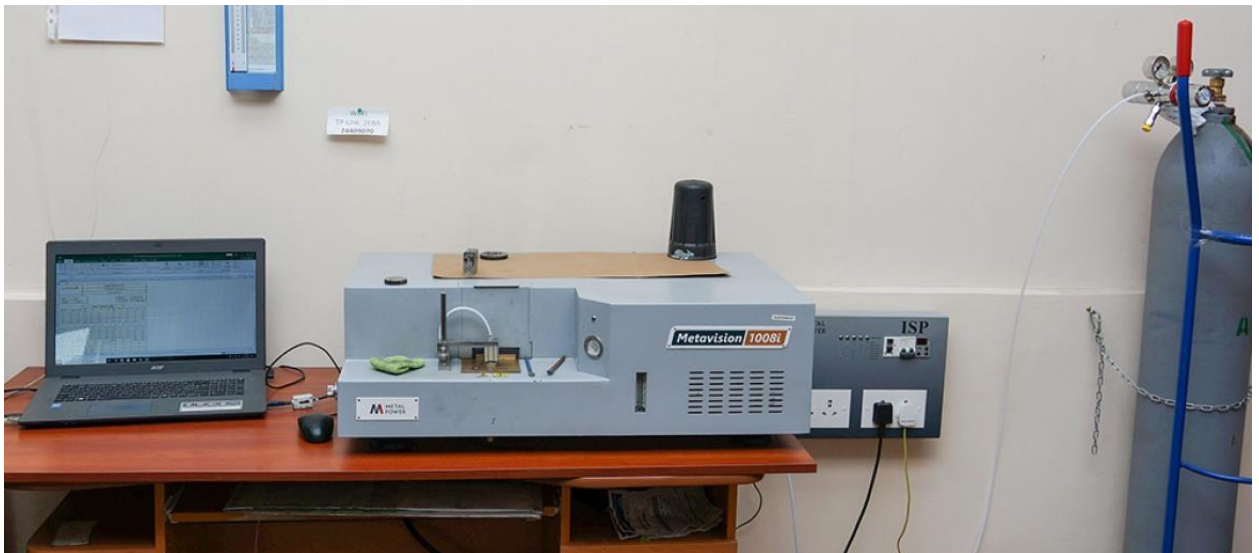
Рис.18. Оптико - емісійний аналізатор Metavision 1008i виробництва компанії MetalPower
