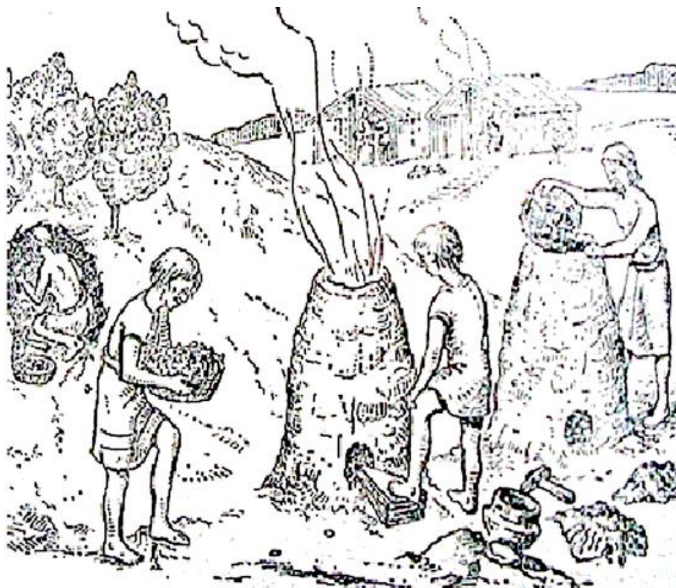
Рис.125. Виробництво кричного заліза сиродутним способом
