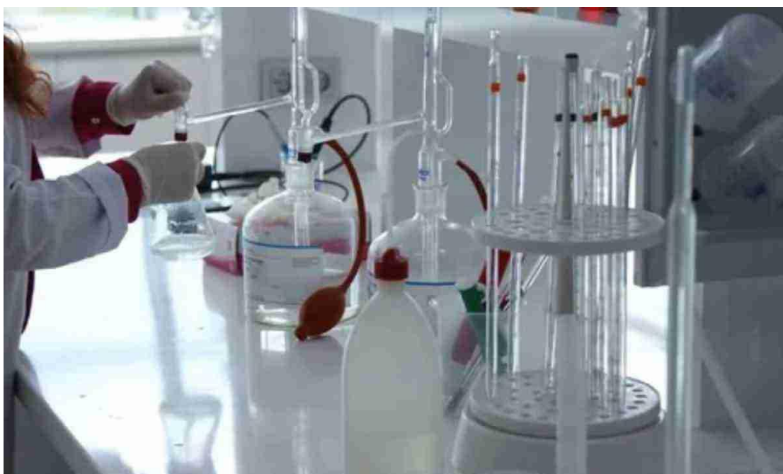
Рис.13. Проведення аналізу хімічного складу історичного артефакту титриметричним методом
