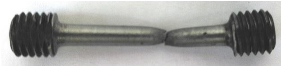
Рис. 44. Зразки для визначення міцності при розтягуванні та пластичності: а – до випробування; б – після випробування.
