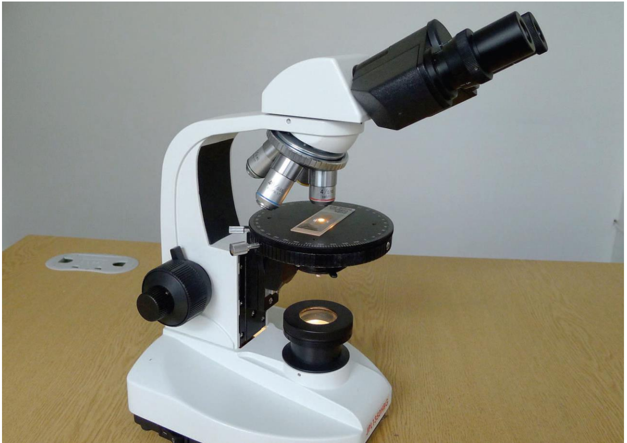
Рис. 145. Поляризаційний світловий мікроскоп, який використовується для петрографічного дослідження тонких зрізів археологічних керамічних артефактів
