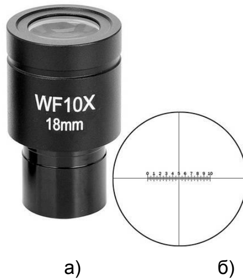
Рис. 67. Окуляр – мікрометр: зовнішній вигляд (а); вимірювальна шкала (б)
