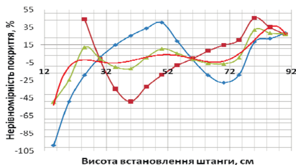
Рисунок 4 – Графічні залежності нерівномірності покриття при міжрядному обробітку з шириною міжрядь 0,45 м для розпилювачів \alpha_\phi = 80^\circ , які рухаються: \blacklozenge – по осі рядка; \blacksquare – рядок розміщений по центру між розпилювачами; \blacktriangle – середнє значення; суцільна лінія – апроксимуюча крива
