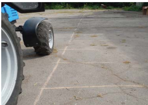
Рисунок 2 – Майданчик для проведення досліджень з твердим покриттям і з нанесеною мірною сіткою
