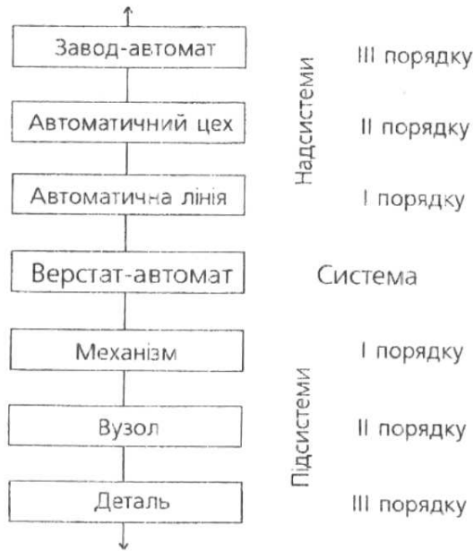
Рис.1.1 – Ієрархія технічної системи на прикладі верстата-автомата [2].
