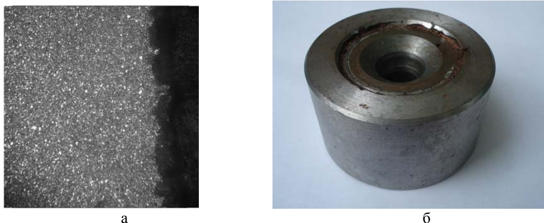
а – мікроструктура ( \times 1730 ) поверхневого шару сплаву ВК8 після РОД бічної поверхні зразка графітовим ЕІ ( I = 50 \text{ A} , P_{cm} = 0,8 \text{ МПа} , F = 73,4 \text{ мм}^2 , h = 3 \text{ мм} ); твердосплавна волока після РОД калібруючої циліндричної напрямної
